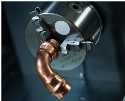
Accesorio rotativo para marcado de piezas cilíndricas
