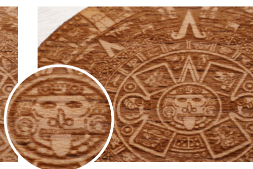
Grabado con lente de 4.0" Un grabado tosco que luce borroso
