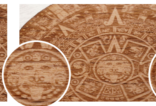
Grabado con lente de 2.0" Un buen resultado, pero faltan algunos detalles mínimos
